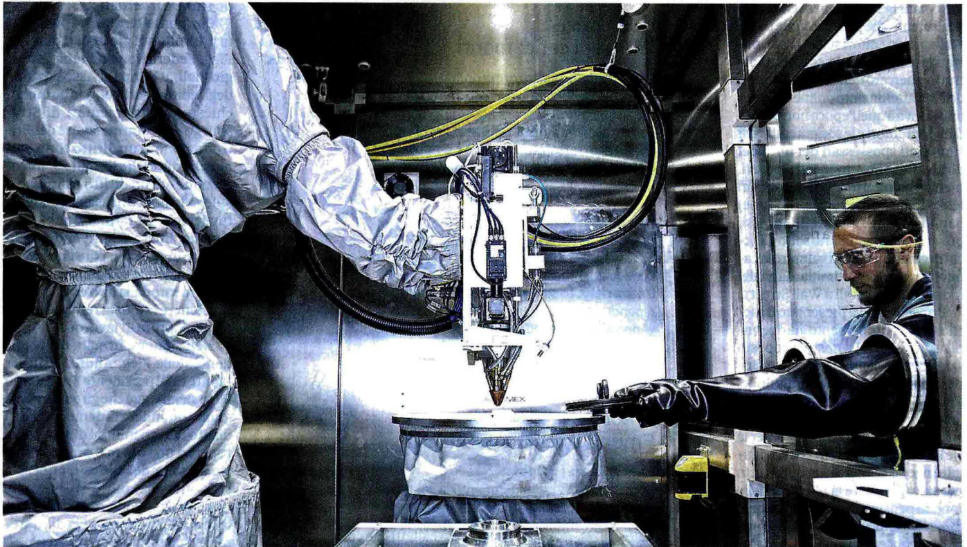
Lo scatto hi-tech Impianto Avio Aero di manifattura additiva a metalli, nel laboratorio di Bari
